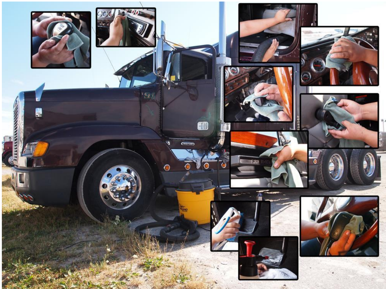
Figure 12: Illustration des zones de contact courantes dans une cabine d'unité motrice nécessitant plus d'attention lors du nettoyage et de la désinfection. Source de la photo : Truck Wash Handbook (Manuel sur le lavage de camions) de l'Ontario Swine Health Board.
