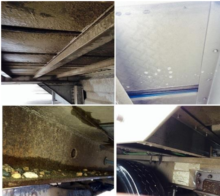
Figure 11: Les photos ci-contre présentent un châssis sale (à gauche) par rapport à un châssis propre (à droite) avant et après être passé dans une station de lavage de châssis.
